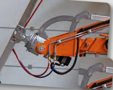
La tête de levage dispose de deux options de réglage via deux trous pour le verrou. Elle peut ainsi être ajustée pour pivoter un peu plus vers le plafond ou le plancher.
