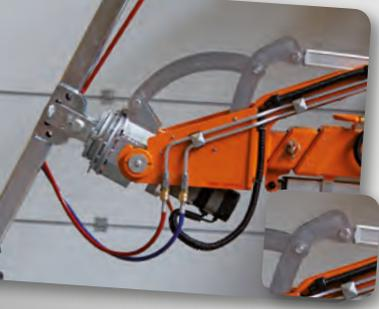
La tête de levage dispose de deux options de réglage via deux trous pour le verrou. Elle peut ainsi être ajustée pour pivoter un peu plus vers le plafond ou le plancher.
