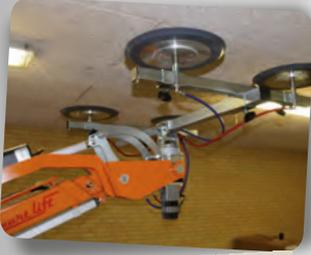
Le chariot de levage peut soulever des articles horizontalement à faible hauteur de plafond.
