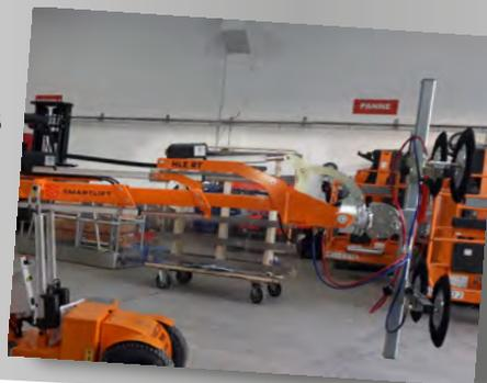
*Le SMARTLIFT est équipé d'une deuxième extension avec sortie à assistance électrique*
